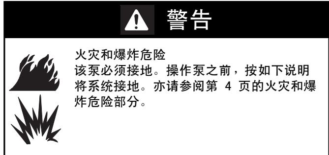
为减少静电火花的风险，应将泵和泵送区域内的所有其他设备接地。请查阅当地的电气法规，了解针对您所在地区和所用设备类型的详细接地说明。使该设备完全接地：
