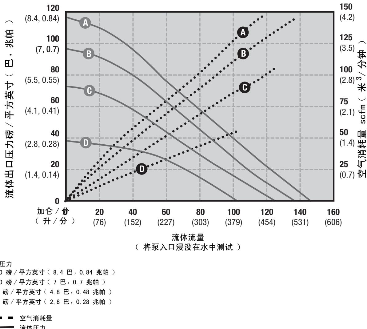
为查找特定的流体流量 (加仑 / 分钟 / 升 / 分钟) 和空气工作压力 (磅 / 平方英寸 / 兆帕 / 巴) 时的流体出口压力 (磅 / 平方英寸 / 巴 / 兆帕):
