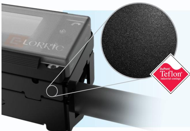
FU-LT 採用不鏽鋼本體,外層則採用 Teflon (鐵氟龍) 塗層加工,Teflon塗層具備抗腐蝕、防黏、絕緣與低摩擦特性,能有效抵禦鹽霧、油氣與工業清潔劑的侵蝕,不易剝落或劣化;此塗層亦無重金屬、低 VOC 排放,不僅環保,更適用於化工、戶外或食品製造等高腐蝕與高潔淨要求環境。
